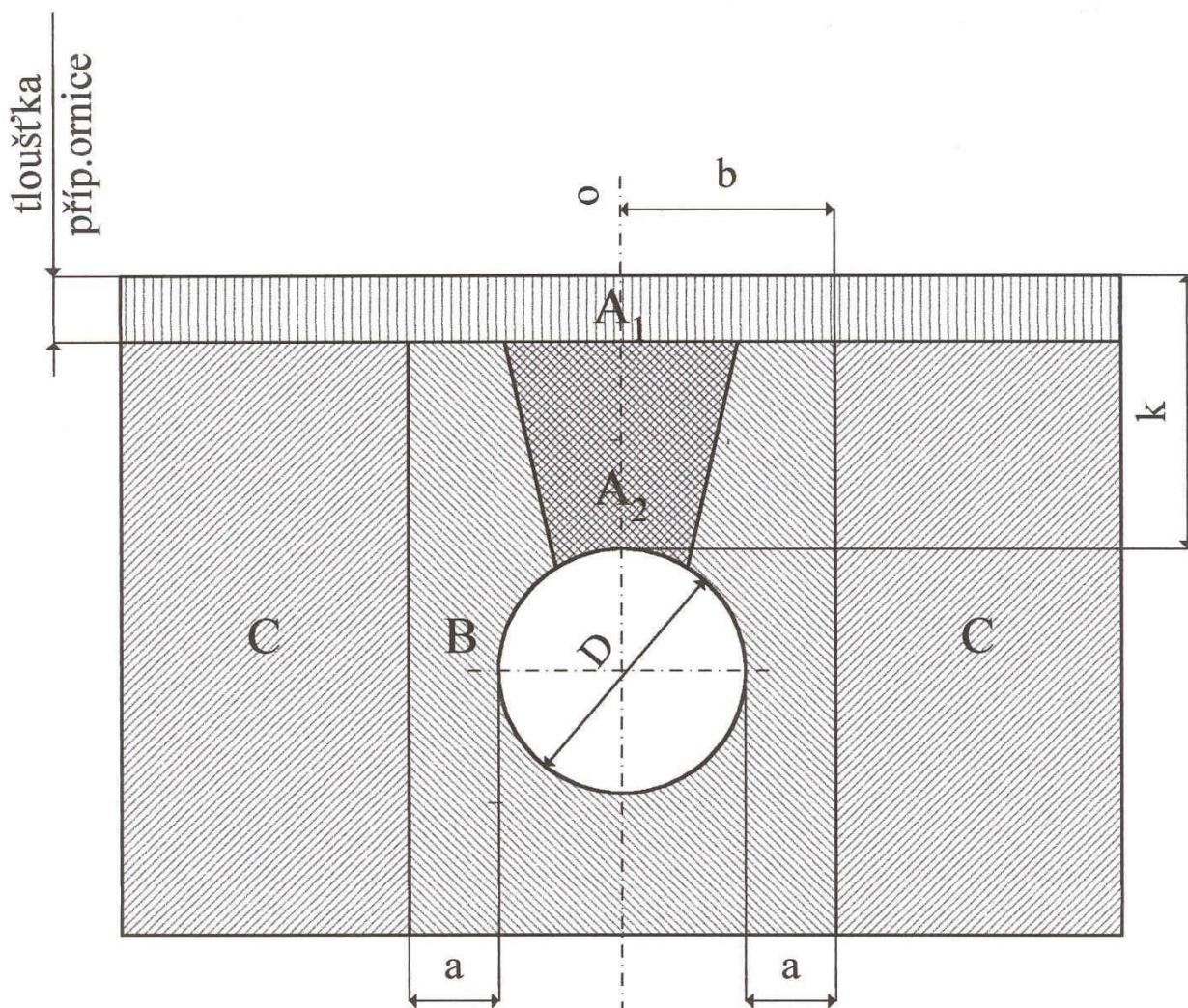
D – vnější průměr potrubí
